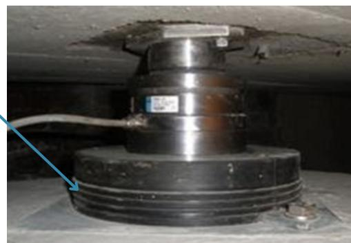
Modèle de capteur de compression unique au monde, qui repose sur un palier élastomère, et qui présente des avantages inégalés par rapport à tous les autres capteurs de compression du marché.
