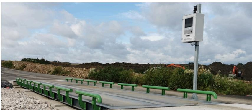
Installation sur banquettes en béton
